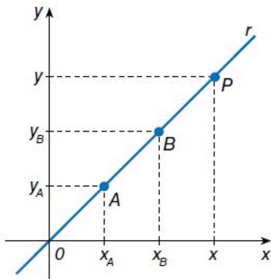
$$\begin{vmatrix} x & y & 1 \\ x_A & y_A & 1 \\ x_B & y_B & 1 \end{vmatrix} = 0 \Rightarrow \underbrace{(y_A - y_B)}_a x + \underbrace{(x_B - x_A)}_b y + \underbrace{(x_A y_B - x_B y_A)}_c = 0$$
