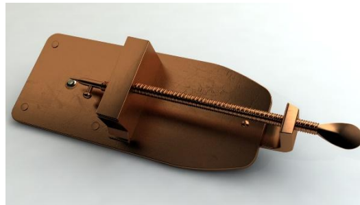
Microscópio utilizado por Leeuwenhoek
