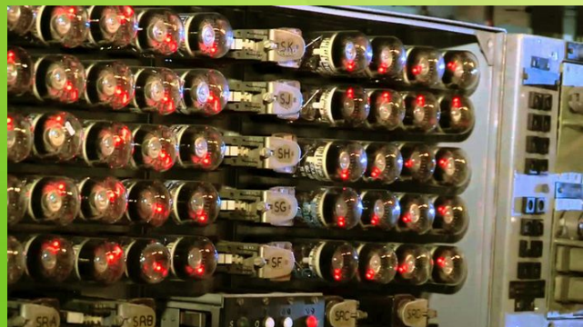
50-60рр. ХХ сторіччя Декатрони - багатоелектродні газорозрядні електровакуумні прилади, в схемах зберігання інформації
