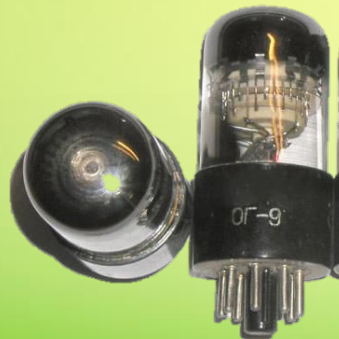
50-60рр. ХХ сторіччя Декатрони - багатоелектродні газорозрядні електровакуумні прилади, в схемах зберігання інформації
