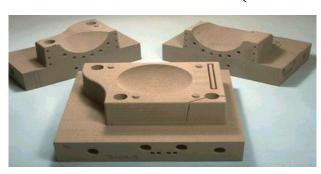
Alumina slipcasting mold
