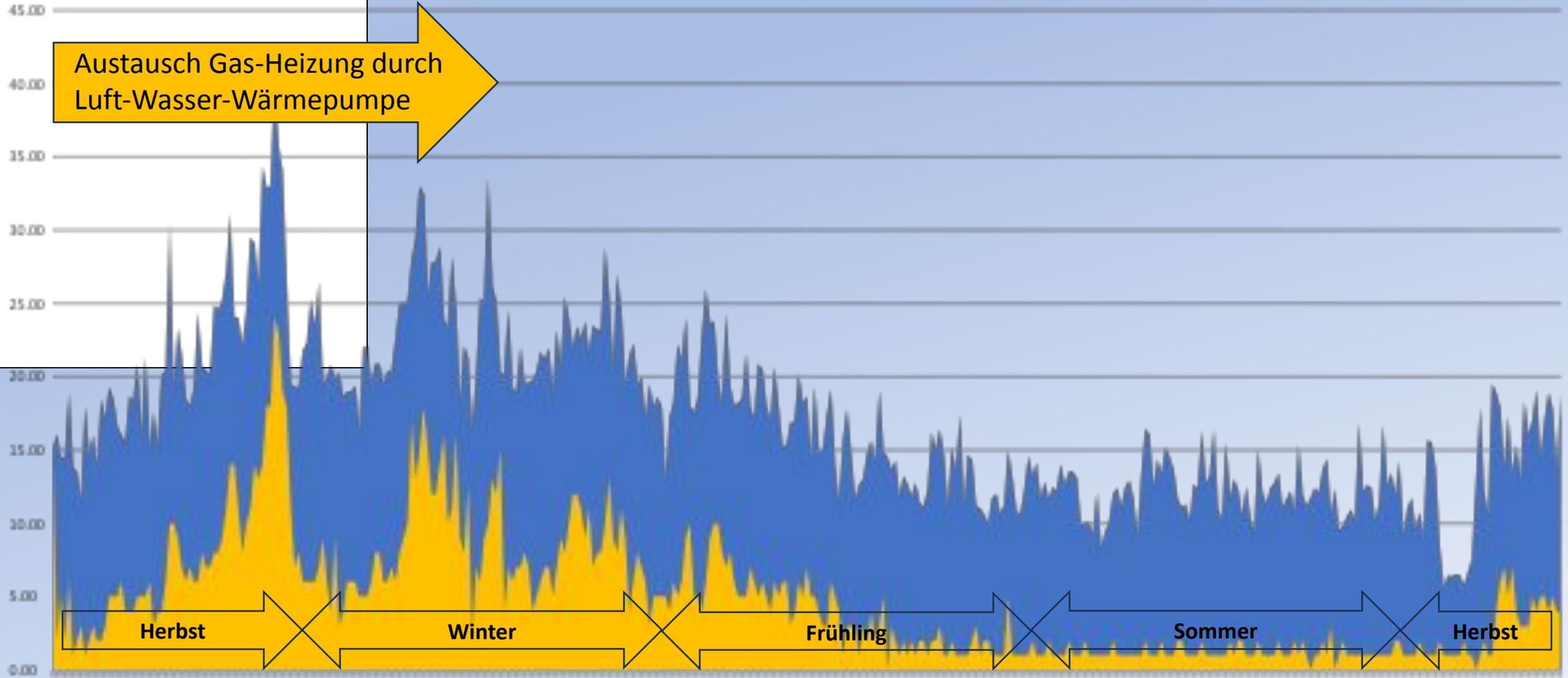
■ Hausverbrauch inkl. Wärmepumpe ■ Strom Wärmepumpe
