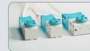
Lors de la programmation de votre robot, on peut ajuster la puissance des moteurs ainsi que les unités: cm, pouces, rotations, degrés et secondes.
