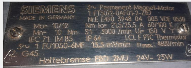
Motore ASSE Z SIEMENS + ENCODER 2000 IMPULSI
