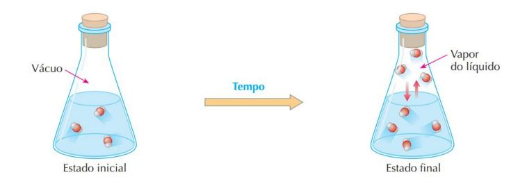
Pressão ou (tensão) máxima de vapor de um líquido é a pressão exercida por seus vapores (vapores saturados) quando estes estão em equilíbrio dinâmico com o líquido.
