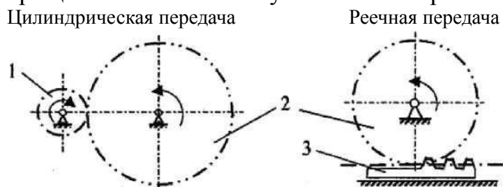
1 - шестерня, 2 - зубчатое колесо, 3 - зубчатая рейка
