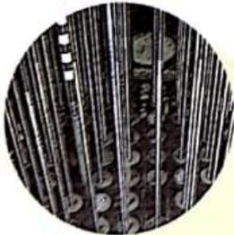
Barras de control elaboradas con cadmio, que absorben los neutrones y los dirigen afuera del reactor con el fin de controlar la velocidad de las fisiones.
