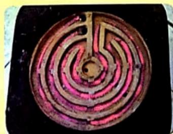
La energía eléctrica, al pasar por una resistencia adecuada, produce aumento de temperatura y luminosidad.
