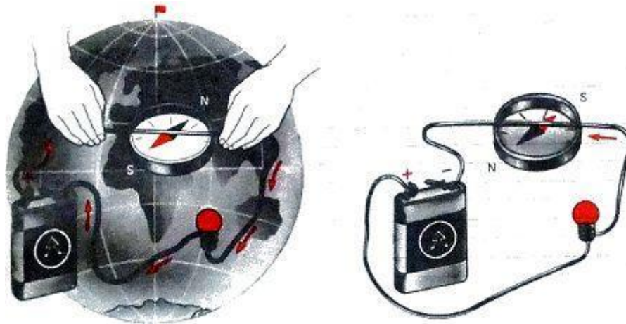
Figura 10. Cuando cambia la dirección de la corriente en el conductor cambia también la dirección de las líneas del campo magnético.
