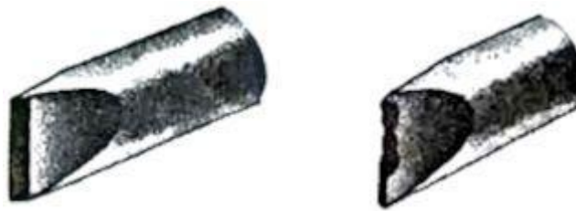
Figura 115. Extremo del corte del soldador (a la izquierda, bien afilado: a la derecha, "quemado")
