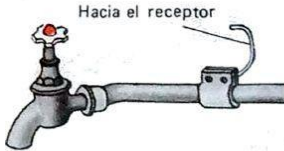
Figura 21. Toma de tierra
