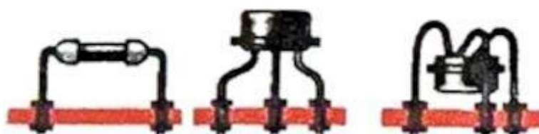
Figura 121. Montaje de elementos sobre remaches huecos (pistones)
