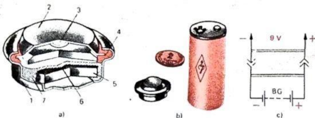
Figura 128. Estructura de un acumulador de cadmio y níquel, de pequeñas dimensiones (a); aspecto exterior del acumulador y de una batería de acumuladores 7Д-0,1 (b) y esquema de conexión de la batería al consumidor de corriente (c)
