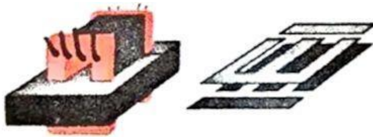
Figura 132. Montaje del circuito magnético de un transformador de red
