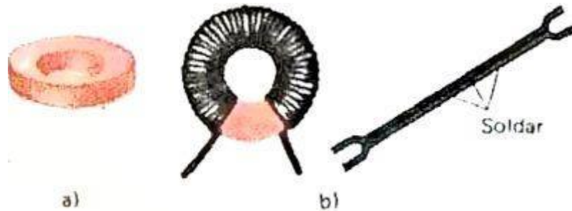
Figura 95. Anillo de ferrita (a), bobina de choque de alta frecuencia (b) y lanzadera de alambre para devanar el hilo
