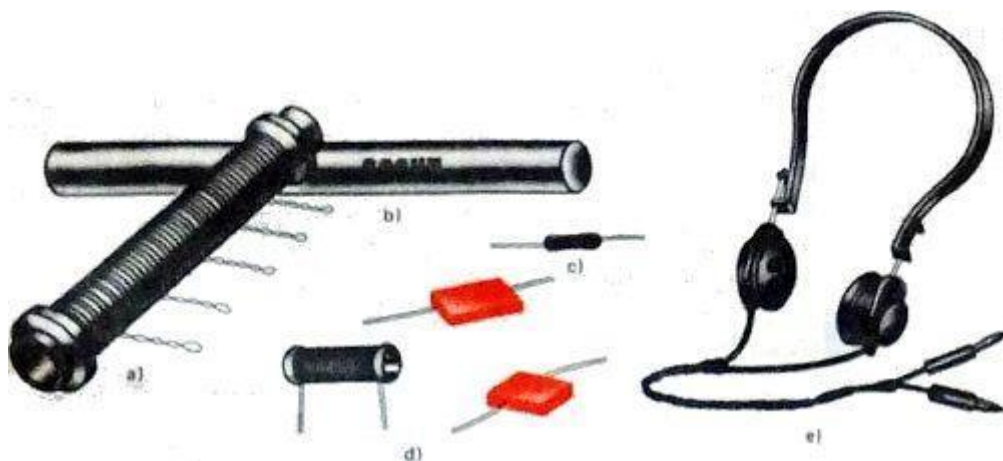
Figura 23, Bobina de inductancia hecha por un aficionado (a), barra de ferrita (b), diodo de punta de contacto (c), condensadores (d) y auriculares (e) necesarios para el receptor experimental.
