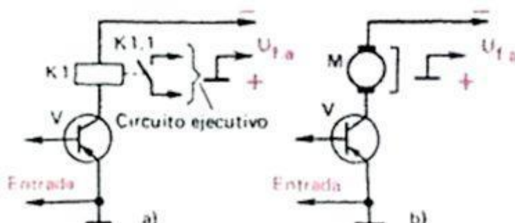
Figura 176. Esquema del relé electrónico
