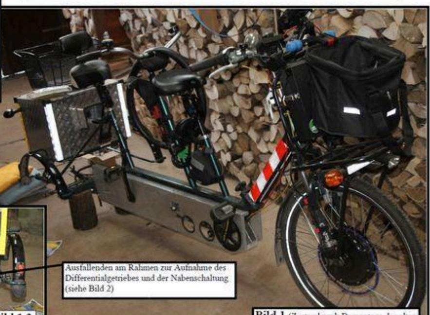
**Bild 1** (Zustand nach Demontage des alten und beschädigten Differential-Getriebes)
