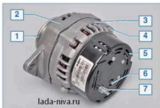
Генератор: 1 – шкив; 2 – передняя крышка; 3 – задняя крышка; 4 – стяжной болт; 5 – кожух; 6 – вывод «D»; 7 – вывод «B+»
