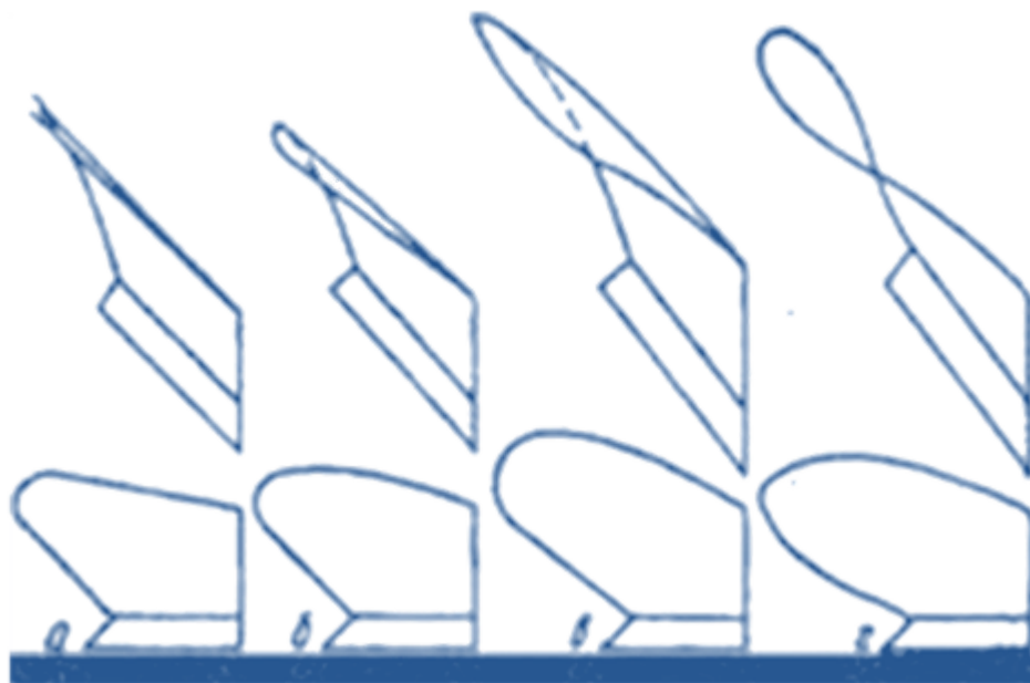
Рис. 1.2.5. Типи полиць: а – циліндрична; б – культурна; в – напівгвинтова; г – гвинтова
