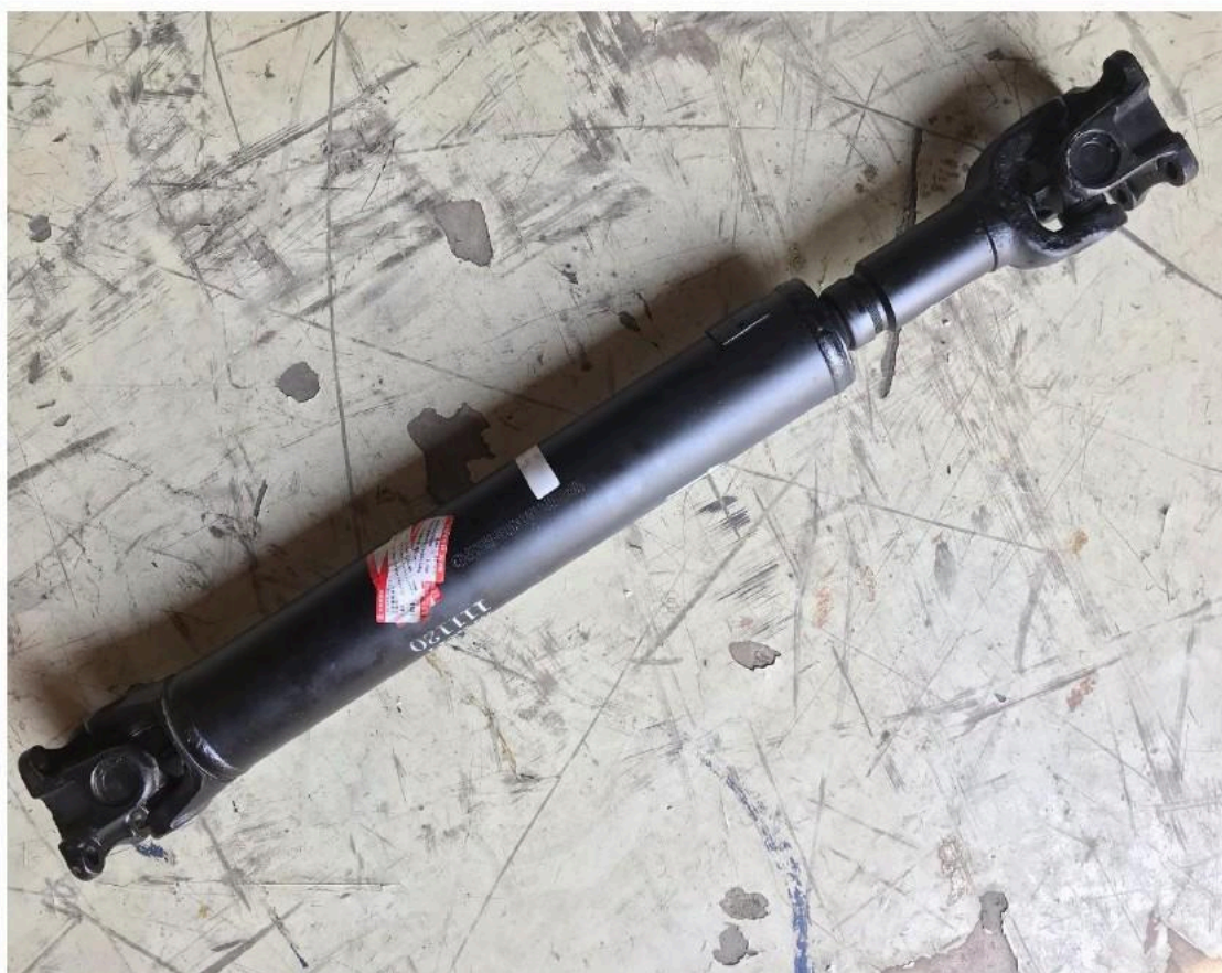
Hình 1.5: Hình ảnh thực tế các đăng VT650-VEAM Motor
