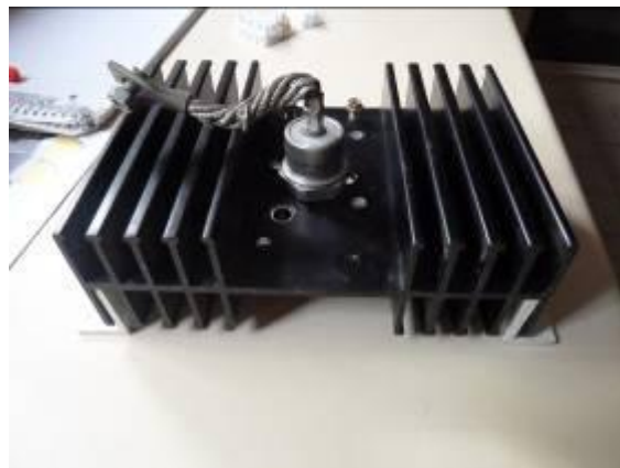
Diode 15A auf Kühlkörper
