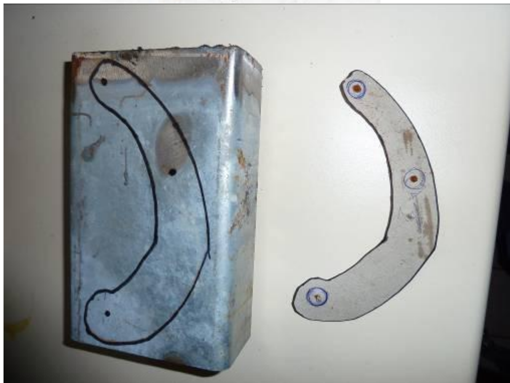
Ersatz selbst gefertigt für Teil Nr. 50 laut Ersatzteil-Liste am Ende!
