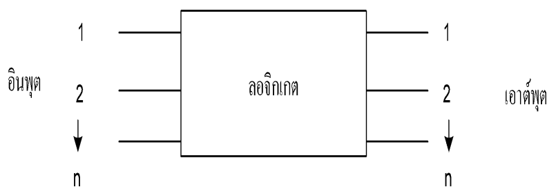
รูปที่ 3.1 วงจรคอมบิเนชัน
