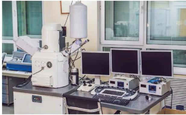
Gambar 1.7 Mikroskop elektron yang digunakan di laboratorium.
