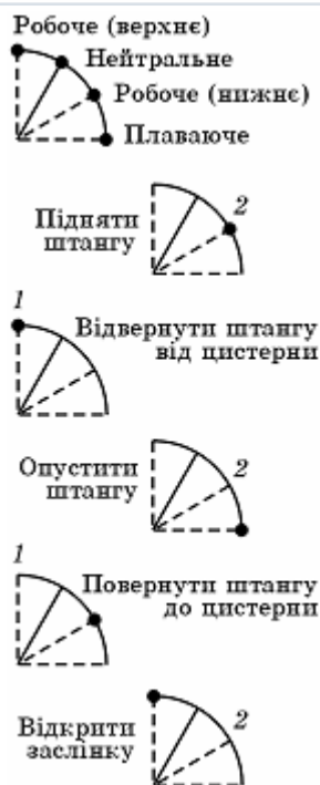
Рис. 11. Положення заслінок для регулювання доз внесення добрив
