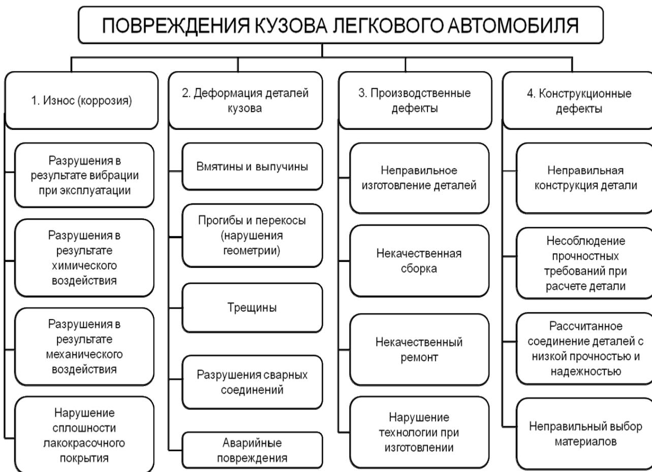
*Рис. 2. Классификация повреждений кузовов и причин их возникновения*
