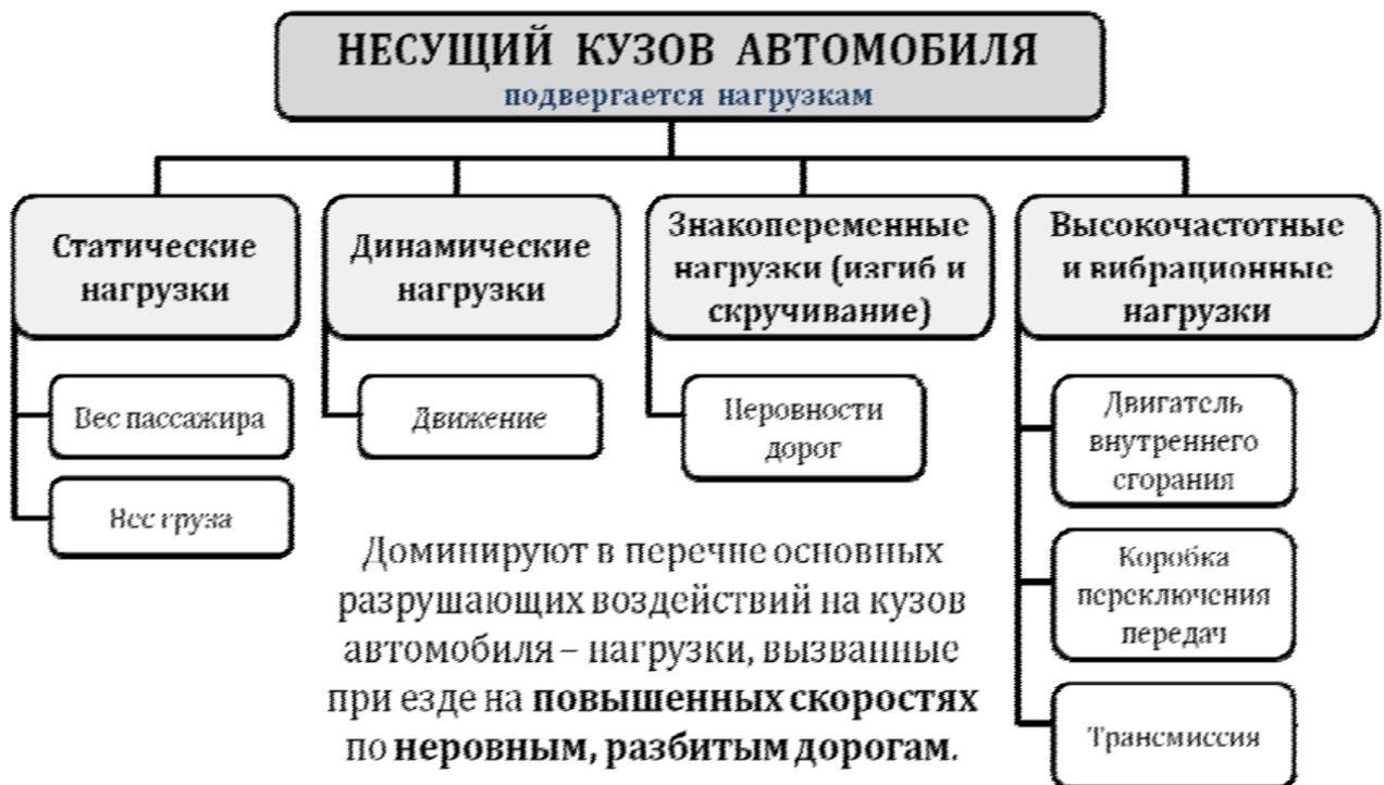
Рис. 1. Классификация внешних и внутренних нагрузок на кузов легкового автомобиля в эксплуатации
