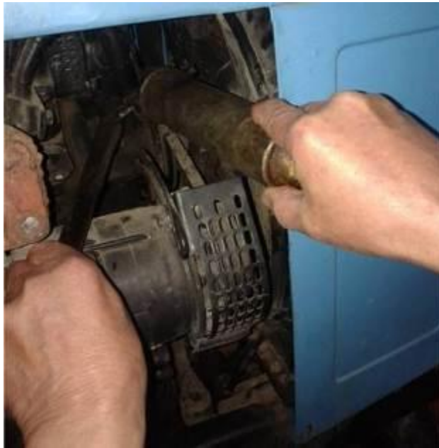
Рис.36. Змащування підшипників вентилятора і насоса трактора МТЗ-80
