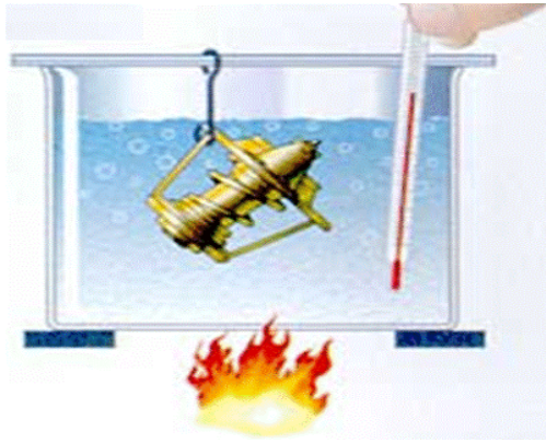
Рис. 38. Перевірка справності термостата
