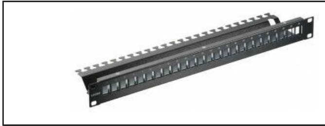
Ce genre de module fait en général 1U de hauteur et permet d'accueillir 24 modules Keystone, ce genre de modules permet par exemple de mettre aussi bien des corps de traverses fibre ou des prises HDMI ou bien dans notre cas des noyaux RJ45. Il y en a de toutes les sortes mais je conseille tout de même de choisir un panneau avec au dos la possibilité de serrer les câbles au panneau avec des colliers de serrage pour pérenniser l'installation.
