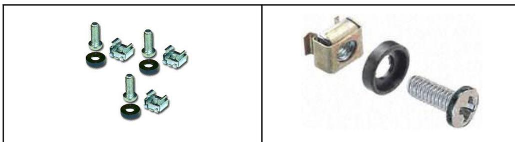
Ce genre d'écrous se mettent sur le rail vertical percé de la baie, puis on y met le module et on le visse, c'est un élément indispensable d'une baie. Il existe plusieurs types de kit d'écrous cage / vis avec des vis cruciformes ou bien Allen (6 pans creux) permettant une couple de serrage de la vis beaucoup plus important sans trop forcer.
