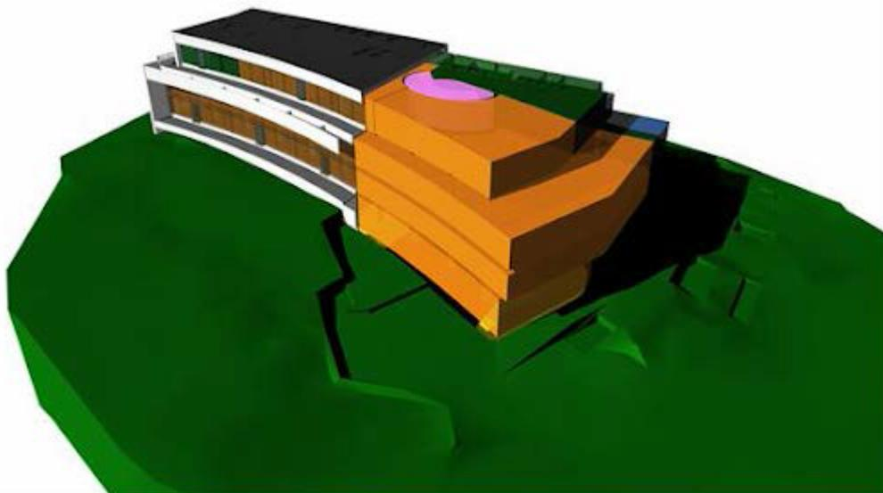
**Рисунок 6 — Пространственная ИМ моделирует внешнюю оболочку здания без деталей и с помощью пространств в качестве объектов с пространственной информацией.**
