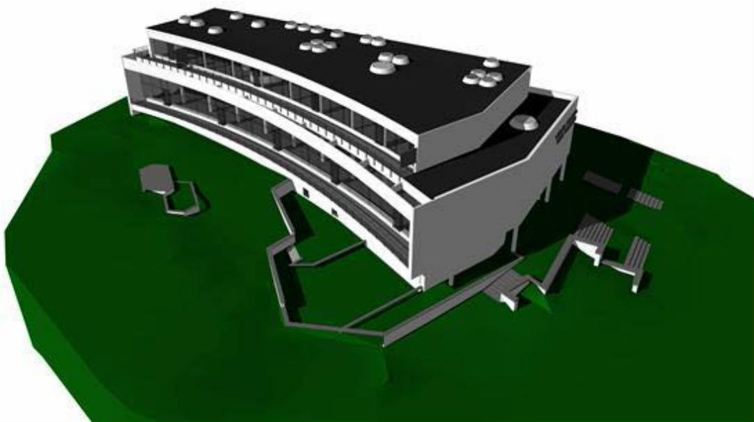
**Рисунок 7 — Модель элементов здания уровня 2. Базовая ИМ Ин, в которой пространства моделируются как элементы с идентификацией пространств и всеми элементами здания. Модель элементов здания уровня 3 дополняется**
