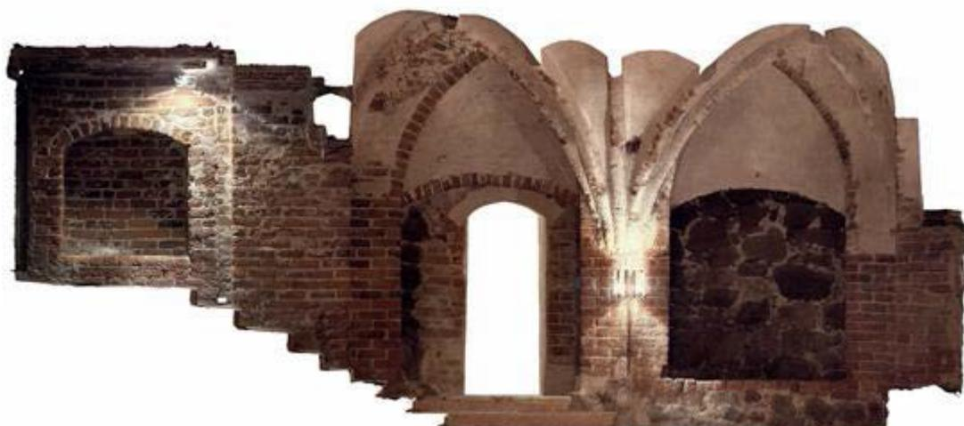
**Рисунок 4 — Выдержка облака точек лазерного сканирования исторического здания, с приложенными сфотографированными данными о цвете.**
