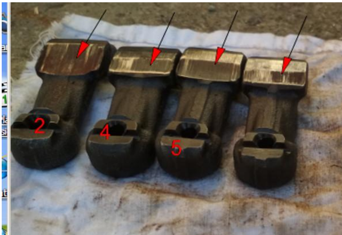
Фото 5. Вот что обнаружилось: стрелки - места износа, цифры - номера рокеров.
