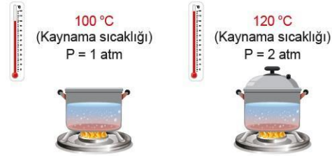
Görsel 4.14: 1 atm ve 2 atm basınç altında suların kaynama sıcaklığı
