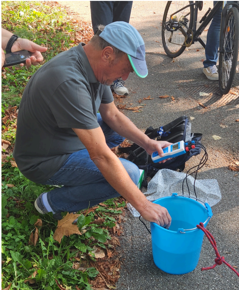
Figura 5.3 – Utilizzo della strumentazione per l'analisi dei parametri chimico fisici dell'acqua
