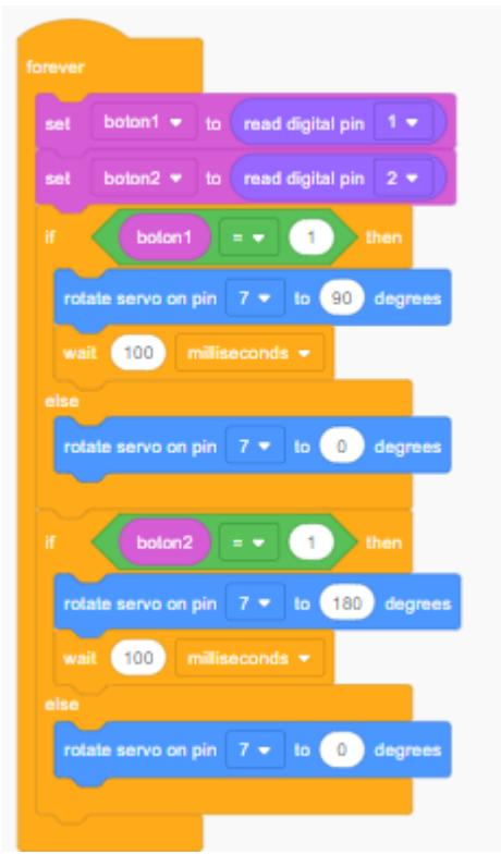
**Reto:** Mejore el programa para que se activen los cinco servomotores mediante los botones que faltan por configurar.
