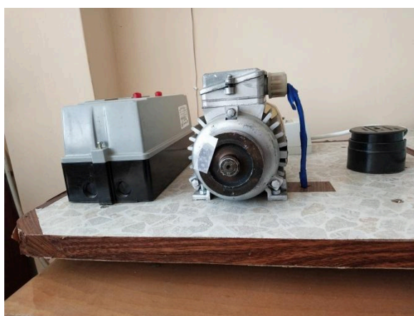
Спецстенд: Дослідження схеми включення трифазного асинхронного двигуна з короткозамкнутим ротором в реверсивному режимі
