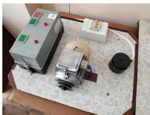
Спецстенд: Дослідження схеми включення трифазного асинхронного двигуна з короткозамкнутим ротором в реверсивному режимі
