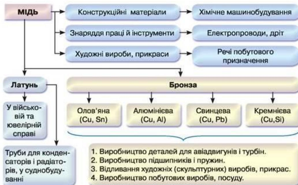
Рис. 50. Схема застосування міді та її сплавів
