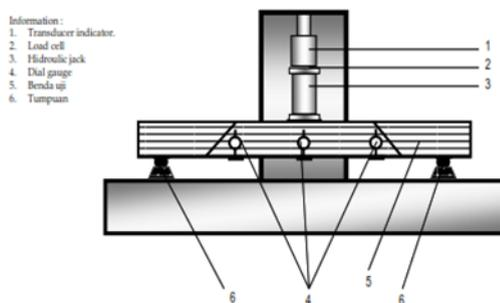
Gambar 2 *Setting up* pengujian balok laminasi
