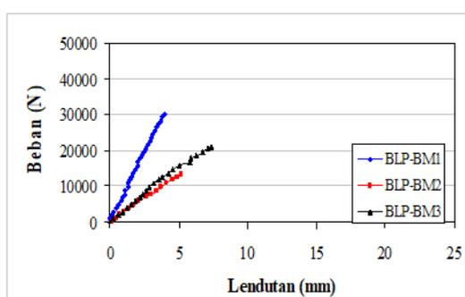
Gambar 3 Grafik hubungan beban-lendutan tiap balok laminasi
