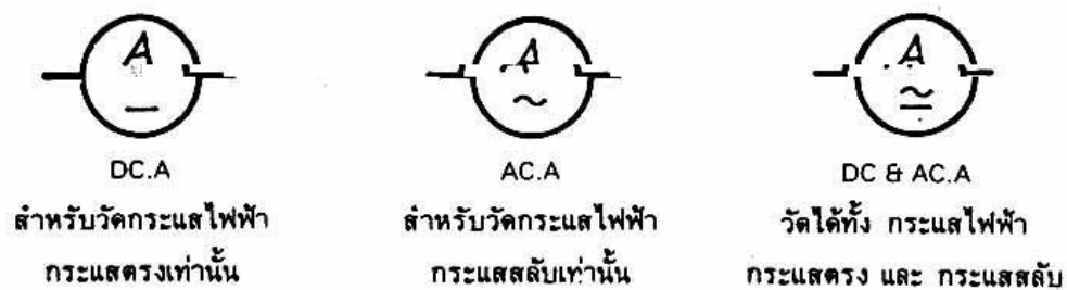
รูปที่ 6-3 แสดงสัญลักษณ์ของแอมมิเตอร์แบบต่างๆ
