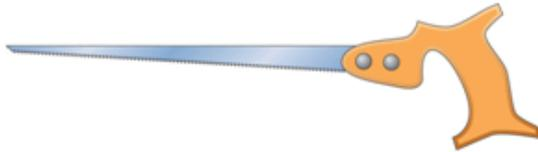
❖ **Serrucho de costilla:** La hoja posee un refuerzo en su parte superior. Se utiliza para efectuar cortes de precisión
