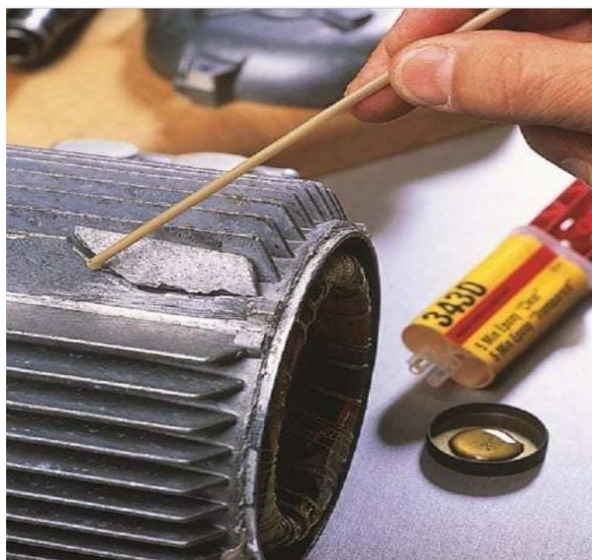
Рисунок 62 – Ремонт склеюванням металевих виробів
