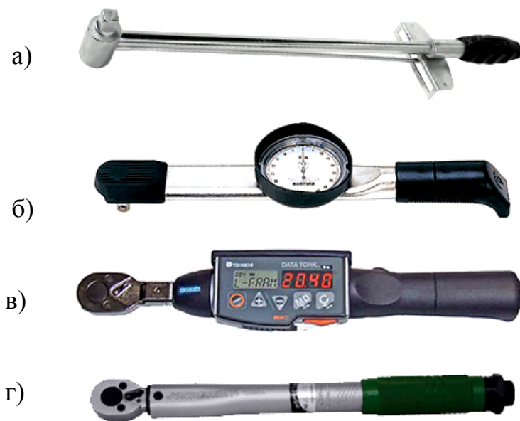
Рисунок 49. Динамометричні ключі: а) – шкальний; б) – стрілочний; в) – електронний; г) – граничний.
