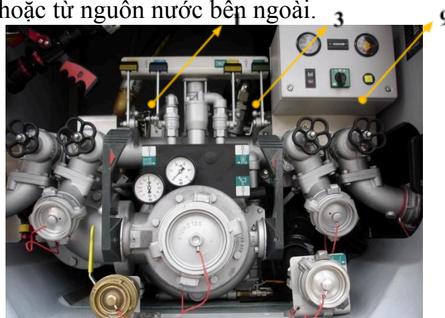
Hình 17: Các vị trí điều khiển lấy thuốc chữa cháy từ téc thuốc của xe để chữa cháy
