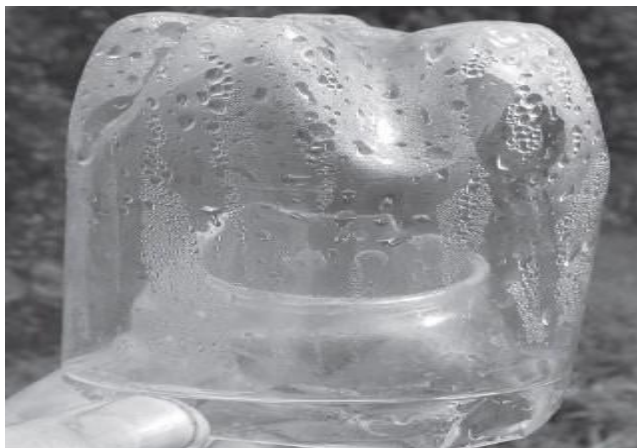
Фото 7. Пристрій для одержання води внаслідок конденсації пари, що випаровується з поверхні ґрунту
