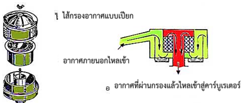
รูปที่ 2.4 : แสดงกรองอากาศแบบเปียก
