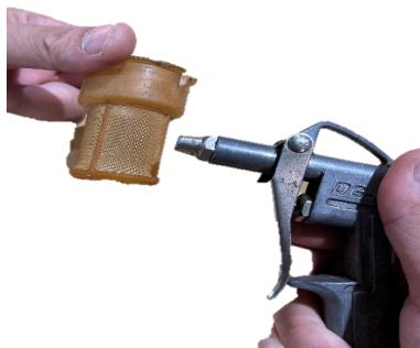
รูปที่ 2.29 : แสดงการใช้ลมเป่าทำความสะอาดกรองน้ำมันเบนซิน
