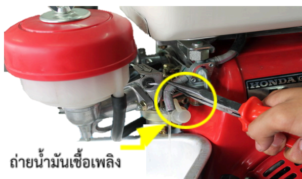
รูปที่ 2.17 : แสดงการถ่ายน้ำมันเชื้อเพลิงออกจากถังน้ำมันเชื้อเพลิง 2.5 ถอดท่อน้ำมันเชื้อเพลิงออกโดยใช้คีมปากจิ้งจก
