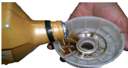
รูปที่ 2.31 : แสดงการเติมน้ำมันหล่อลื่นในหม้อกรอง
