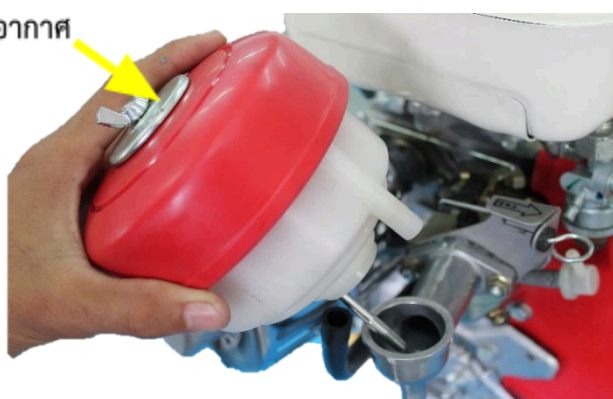
รูปที่ 2.18 : แสดงการถอดท่อน้ำมันเชื้อเพลิง 2.6 คลายนัดทุกระต่ายยึดหม้อกรองอากาศและยกออกทั้งชุด
