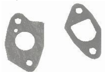
รูปที่ 2.22 : แสดงการตรวจสอบดูปะเก็นและไฟเบอร์คาร์บูเรเตอร์
