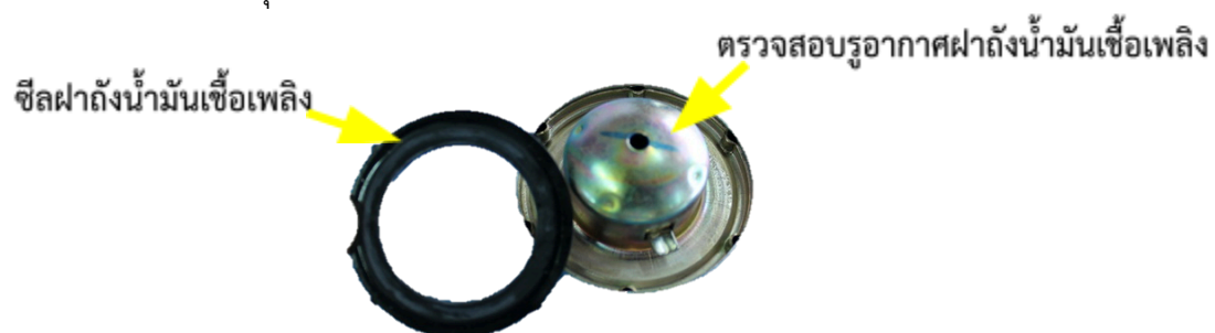
รูปที่ 2.16 : แสดงการตรวจสอบซีลฝาและรูฝาถังน้ำมันเชื้อเพลิง
