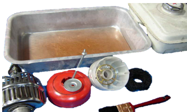
รูปที่ 2.30 : แสดงการล้าง ทำความสะอาดชิ้นส่วนกรองอากาศ
