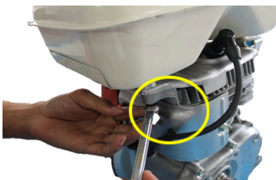
รูปที่ 2.24 : แสดงการถอดโบลต์ยึดถังน้ำมันเชื้อเพลิง
