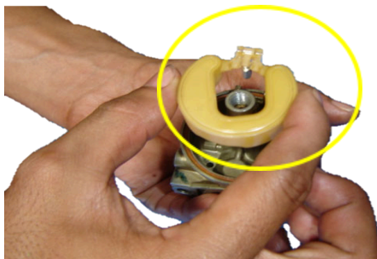
รูปที่ 2.35 : แสดงการถอดลูกลอยคาร์บูเรเตอร์
