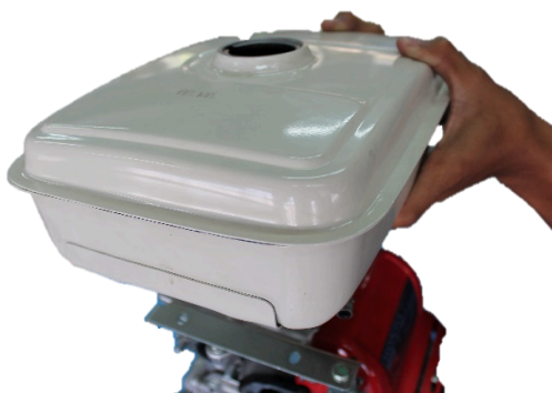
รูปที่ 2.25 : แสดงการถอดถังน้ำมันเชื้อเพลิง
