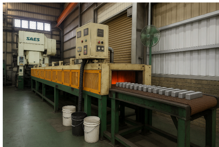
圖 1 連續爐加熱示意圖。前端為連續爐入口, 後端出口則接往鍛機。
