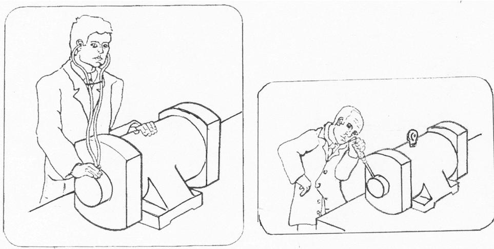
Gambar 5.13 Pengujian getaran motor
