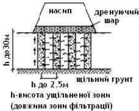
Рис. 2.2.14. Схема ущільнення ґрунтів за допомогою вертикальних дренажів.
