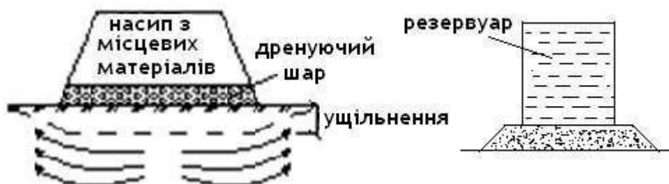
Рис. 2.2.13. Схема ущільнення статичним навантаженням.
