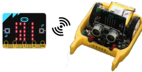
Un robot Maqueen avec 2 cartes micro:bit et batteries
