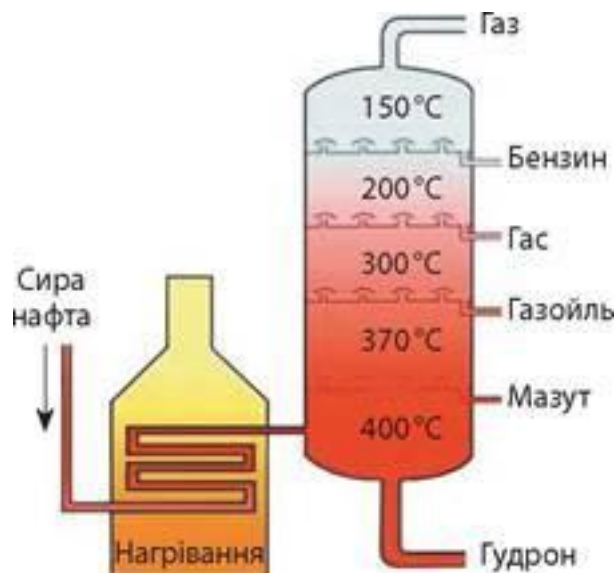
Мал. 29.2. Схема перегонки нафти в ректифікаційній колоні
