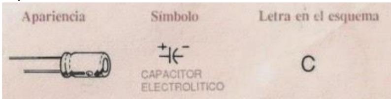
**Función:** Los Capacitores o condensadores electrolíticos almacenan cantidades relativamente grandes de energía eléctrica. Poseen polaridad; lo que significa que tienen un terminal positivo y un terminal negativo y, por tanto, se debe tener "cuidado" al conectarlos en un circuito. deben instalarse en la dirección correcta.
