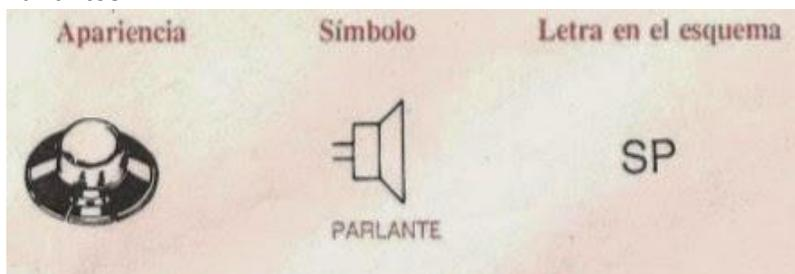
Función: El propósito del parlante es producir sonido convirtiendo la corriente que fluye a través de él, en ondas sonoras. Se puede usar como micrófono invirtiendo las ondas sonoras en flujo de corriente
