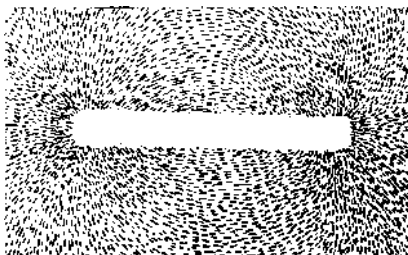
Рис. 39. Розміщення феромагнітного порошку біля тріщини під дією магнітного поля.
