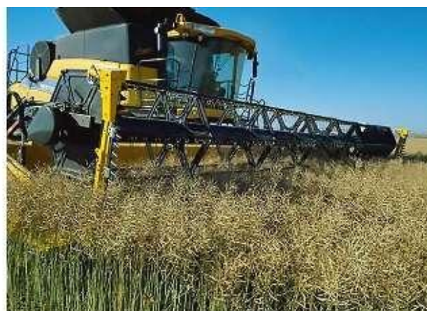
Рис. 11.4. Схема збільшення довжини платформи (а) та комбайн NEW HOLLAND із жаткою Varifeed під час збирання ріпаку
