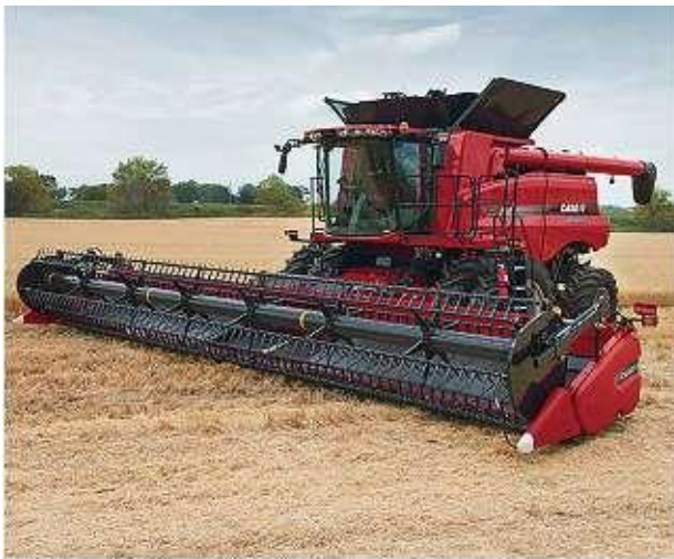
Рис. 11.7. Жатка моделі Case IH 3162 в агрегаті та її робочі органи — мотовило, стрічковий транспортер і додатковий шнек
