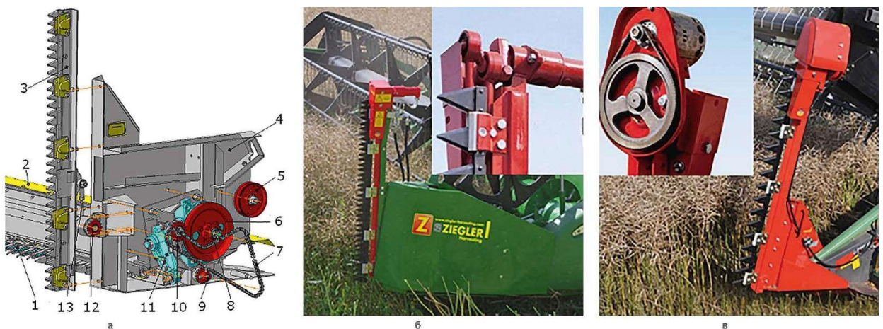
Рис. 11.9. Активні ділянки з механічним (а), гідравлічним (б) та електричним приводом ножів
