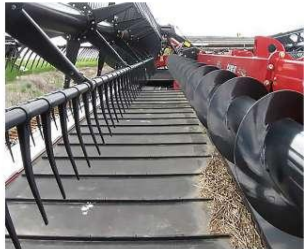
Рис. 11.7. Жатка моделі Case IH 3162 в агрегаті та її робочі органи — мотовило, стрічковий транспортер і додатковий шнек
