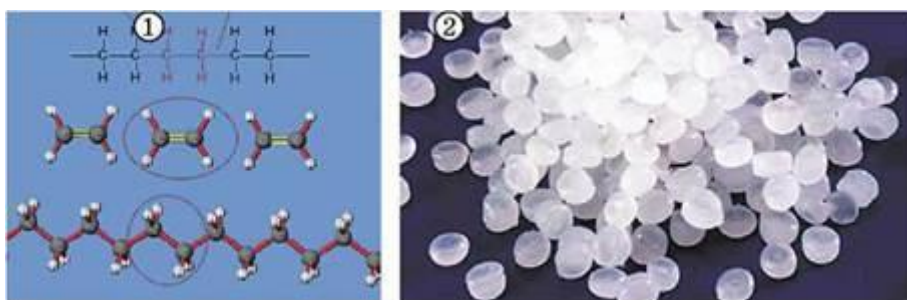
Рис. 29.3. Полімеризація етилену (етену). 2. Гранули поліетилену
