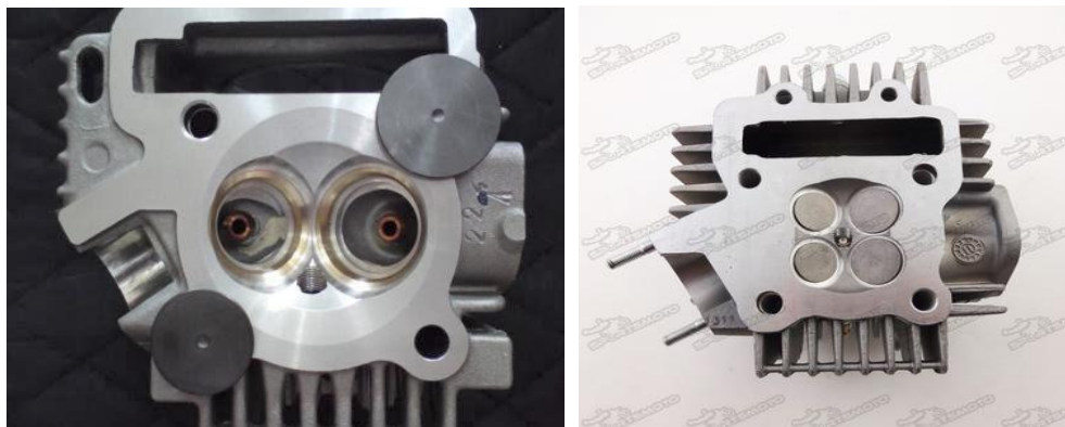
Gambar 2.3. Bentuk Ruang Bakar Engine 4T
