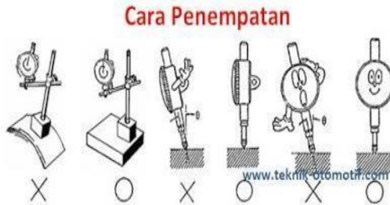
Gambar 2.43. Cara penempatan spindle
