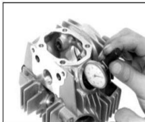
Gambar 3.7. Pengukuran kekocakan/kerenggangan katup dengan bushing
