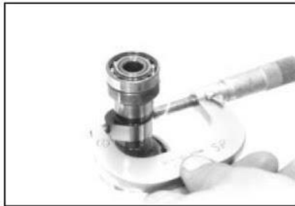
Gambar 3.5. Pemeriksaan Tinggi Angkat Katup
