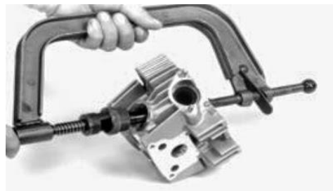
Gambar 2.52. Melepas katup dengan valve spring compressor
