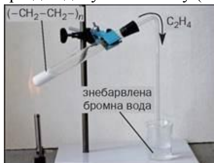
Мал. 85. Розклад поліетилену і знебарвлення етенем бромної води ВИСНОВКИ
