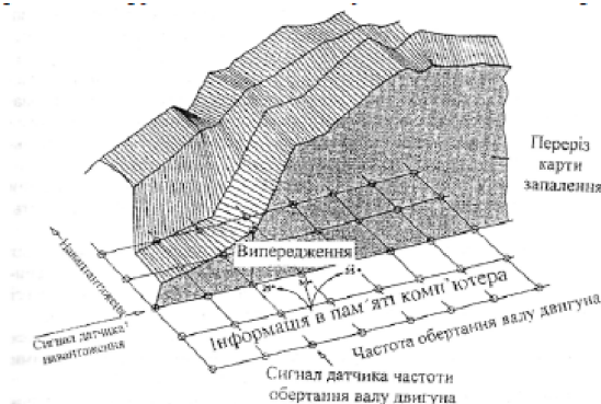
Рис. 8.8 - Карта кутів випередження запалювання
