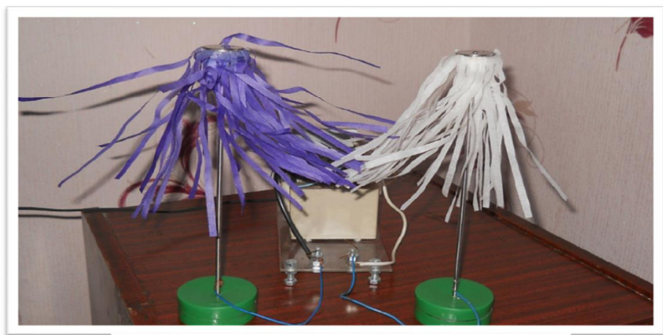
Рис.3. Зібраний за схемою високовольтний підсилювач
